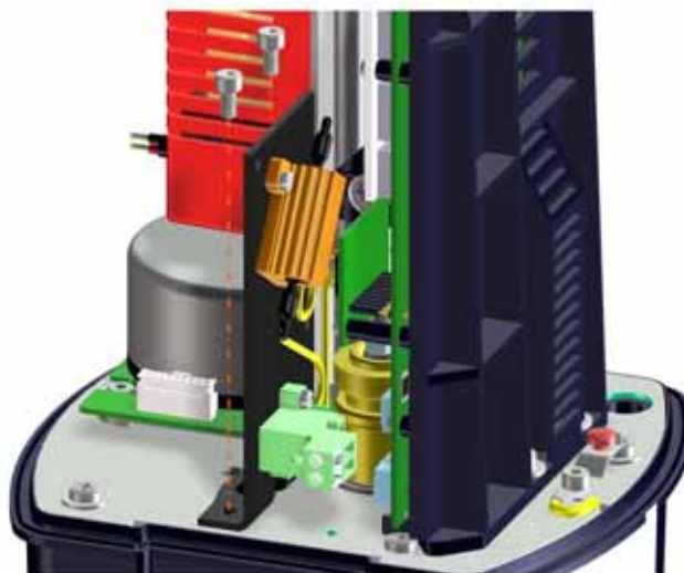
рис. 11: Монтаж обогрева ARI-PREMIO®-Plus 2G 2,2 - 25 кН
